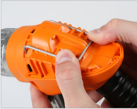
Haltebügel herunterdrücken bis er einschnappt. Push down retaining bracket until it snaps in.
