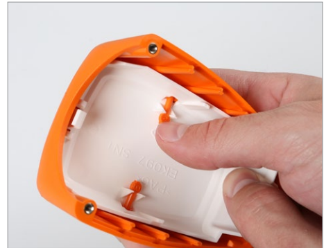
Abdeckung oben und Werbefläche EK 097 SNT miteinander verbinden: Dafür die Haken durch die Öffnungen der Werbefläche führen und einrasten. Connect top of scuffguard and nozzle talker EK 097 SNT: Push the hooks through the openings in the nozzle talker and snap them in.
