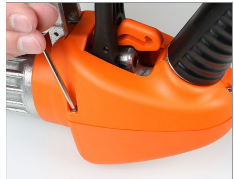
Schrauben EB 870 einlegen (3 Stück) und mit Inbusschlüssel festschrauben. Fix parts with 3 screws EB 870 and hexagon spanner.
